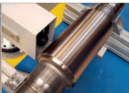
Foto 2: Walsrollen met een nieuw ontwikkelde bekleding ter vervanging van CrVI-bekleding, geproduceerd in de elektro galvanisatie pilootlijn
