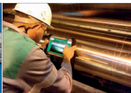
Foto 3: Slim evaluatie-instrument voor werkwalsen
