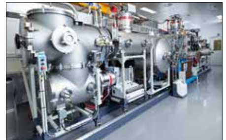
'Roll-to-Roll'-pilotlijn voor de opschaling van de coating van roestvaste bipolaire platen voor brandstofcellen
