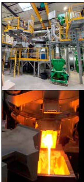
Fig. 1 – Piloot-plasmaoven voor de simulatie van EAF, SAF en slak valorisatieroutes
