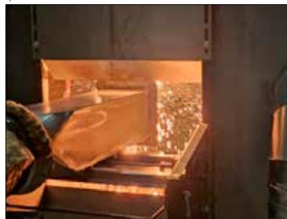
Fig. 4 - Installation pilote de granulation de laitier à sec
