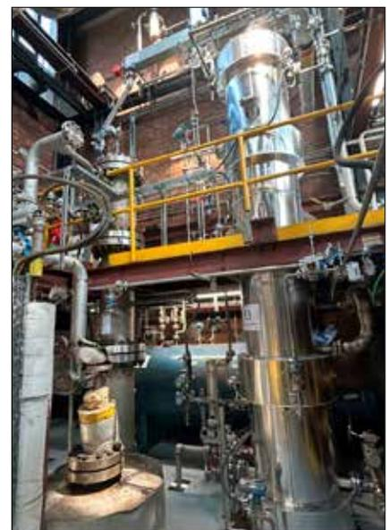
Fig. 5 - Installation pilote PiCaSo (1000 Nm<sup>3</sup>/h) pour le captage du CO<sub>2</sub> par absorption
