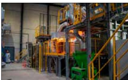
Fig. 2 - Four pilote plasma pour simulation EAF, SAF ou des routes de valorisation des scories
