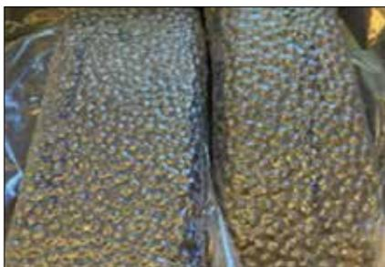
Fig. 1 - Échantillons (emballés sous vide) de DRI produit au CRM Group à l'échelle pilote
