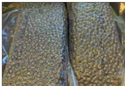
Fig. 1 - DRI-monsters (vacuüm verpakt) geproduceerd in de piloot DRI-installaties
