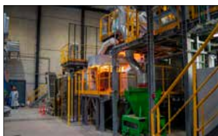
Fig. 2 - Piloot plasma-oven voor de simulatie van EAF, SAF en slak valorisatieroutes
