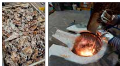
Fig. 3 - Schroot smelten om kwaliteitsverbetering te beoordelen na schroot sorteren en verwerken
