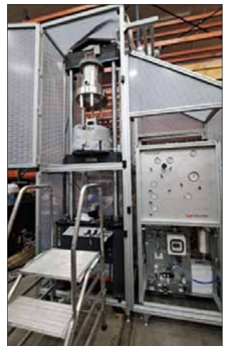
Fig. 4 – Installations d'essai pour le comportement de matériaux exposés à l'hydrogène
