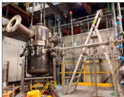
Fig. 1 – Réacteur pour la réduction directe du fer
